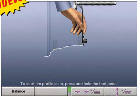
Dibuja la forma exacta del rin con el brazo Dataset® interior. La máquina utiliza esta información para determinar las posiciones óptimas para las pesas basado en tecnología SmartWeight. El operador también puede seleccionar posiciones alternativas.
