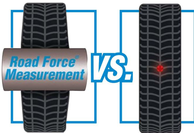
**Sistemas que no hacen contacto con el neumático frecuentemente tienen resultados inconsistentes debido a que no aplican presión al neumático para probarlo. Algunas de estas máquinas ni siquiera miden los hombros del neumático.**
