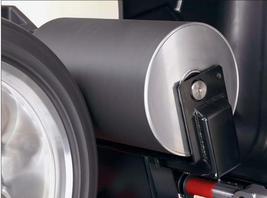
El exclusivo sistema Road Force Measurement® aplica hasta 630 Kgs. (1,400 libras) de presión al neumático, mientras sensores en el rodillo de fuerza detectan vibraciones no relacionados con balance. Estas vibraciones generalmente son debidos a variación de fuerza radial o eccentricidad geométrica de los neumáticos, o alabeo del rin.
