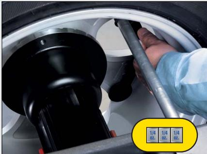
*... ARRIBA en las pestañas del rin, la balancadora automáticamente selecciona el modo de pesas de grapa.*
