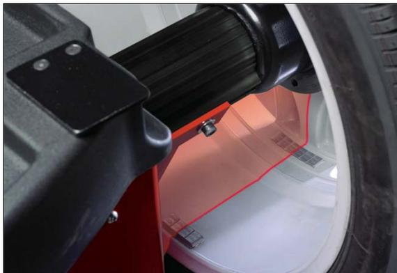
El laser se activa automáticamente e identifica la posición 6:00 para asistir con la colocación de pesas adhesivas. Ayuda al operario a identificar la posición óptima para las pesas.
