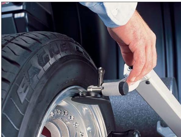
**Puede medir alabeo del rin sin desmontar el neumático ...**
