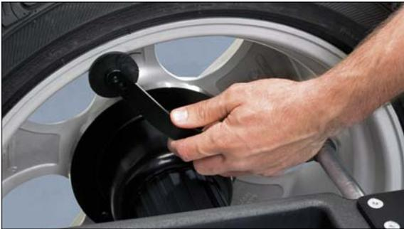
El brazo Dataset® interior determina la ubicación exacta para las pesas y toma las medidas de rines de hasta 30" (762 mm) de diámetro.
