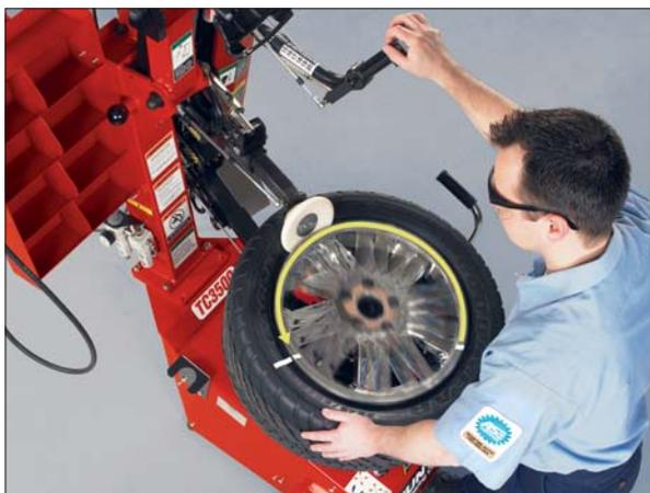
La característica patentada ForceMatching® de Hunter une el punto de menor flexibilidad del neumático con el punto de mayor alabeo radial negativa del rin. Este procedimiento cancela las vibraciones causadas por el neumático y el rin.
