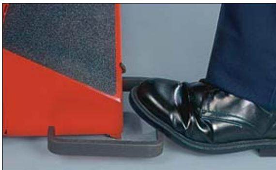
Oprima el pedal para activar la entrada de datos. El pedal también traba el eje para ayudar cuando enrosca o desenrosca la tuerca.
