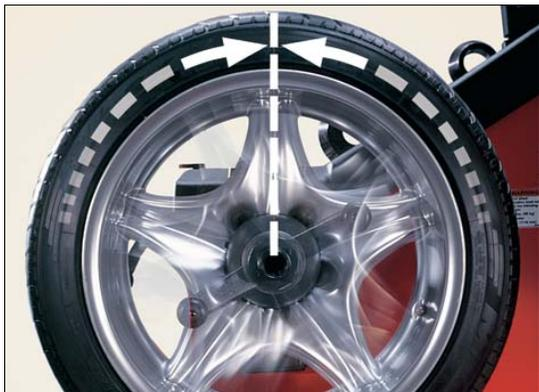
Servo Stop para la rueda automáticamente en la posición correcta para colocar cada pesa. Se puede activar con el toque de un botón o simplemente empujando la rueda con la mano.
